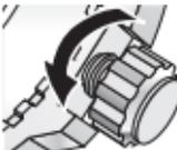
りゅうずが飛び出すまで、左に回す |
