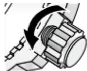
リゅうずが飛び出す<br>まで、左に回す |
